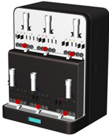
그림 1. 개발 중인 자동 합성 장치 및 안테나 설치 위치 Fig. 1. Image of the developing automatic preparation system and disposable cassettes installation positions
