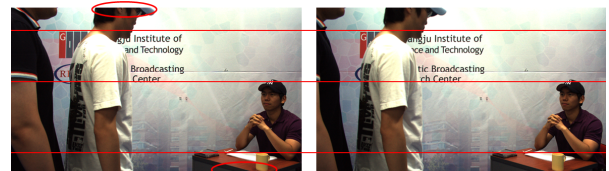
그림 2. 실제 영상에서의 정렬화 과정을 거친 후 상태 Fig. 2. Rectified result of left and right images
