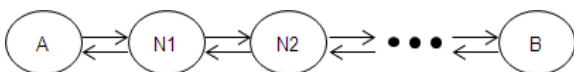
그림 6. 고려하는 네트워크 코딩 토폴로지: Chain Fig. 6. A network coding aware topology: Chain
