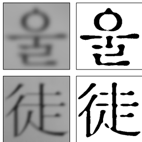
그림 3. Sauvola 알고리즘에 의한 이진화된 문자영상 Fig. 3. Binary character image by Sauvola algorithm
