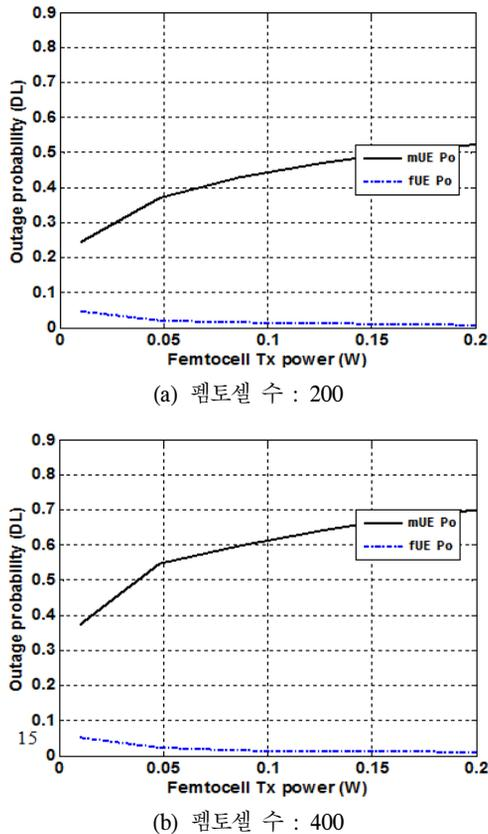
그림 5. mUE와 fUE의 outage probability (penetration loss : 5dB)
