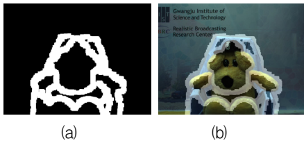
그림 5. 깊이 불연속 영역 생성 Fig. 5. Depth discontinuity region generation
