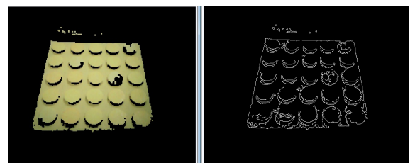
그림 1. Canny 에지 영상처리 후 검출되는 외곽선 Fig. 1. Outline of Canny edge detected image
