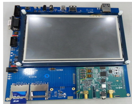
그림 11. 구현된 수신모듈이 장착된 임베디드 방송 수신기 Fig. 11. Embedded Broadcast Receiver with the Implemented Reception Modules
