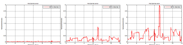
그림 9. 위성 차단각 40도 일 때의 수평 위치오차 - 항법메세지 보정정보 오차: 0ns(좌), 2ns(중), 5ns(우) Fig. 9. Horizontal error(Mask angle: 40°) - Uncertainty of message correction: 0ns(left), 2ns(middle) and 5ns(right)
