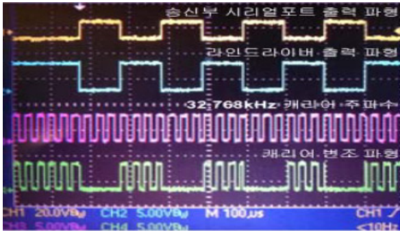
그림 8. 32.768 kHz 저주파 캐리어 기반 가시광 통신에서 그림 2와 그림 3 회로 안의 송신부 시리얼포트 출력, 라인드라이버 출력, 32.768kHz 캐리어 신호, 캐리어 변조된 신호파형.
