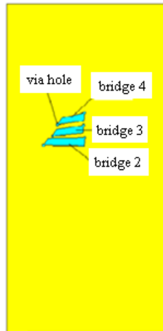
그림 6. Quasi Möbius Strip Antenna의 후면도 Fig. 6. Back View of the Quasi Möbius Strip Antenna
