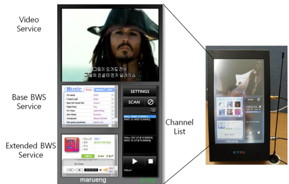
그림 10. 계층 연동형 BWS 검증 플랫폼 Fig. 10. Verification platform for scalable BWS
