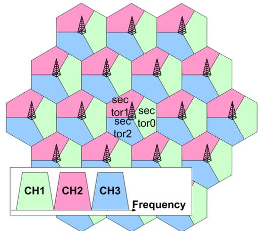
그림 4. 모의실험에 이용된 주파수 재사용률 1/3인 매크로셀의 사용 주파수 채널
