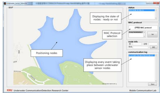
그림 8. 지상 제어국 GUI 프로그램의 구성
