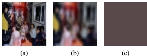
그림 3. 평균 필터 결과 영상. (a) 작은 크기 필터 결과 영상, (b) 중간 크기 필터 결과 영상, (c) 큰 크기 필터 결과 영상 Fig. 3. Average filtered images. (a) is the resulting image by small scale filter, (b) is the resulting image by middle scale filter, and (c) is the resulting image by large scale filter.
