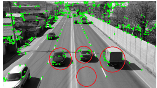
그림 7. 이미지 전 영역에서의 코너 검출 Fig. 7. Corner detection in all area
