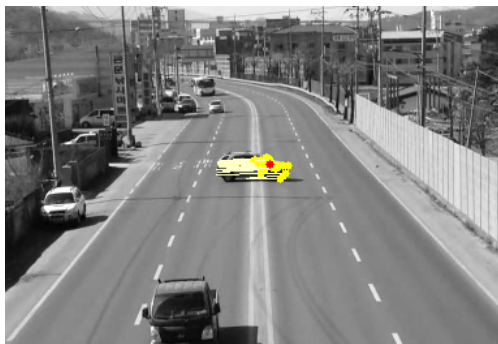
그림 14. 불법 유턴 차량 검지 Fig. 14. Detection of illegal U-turn vehicle
