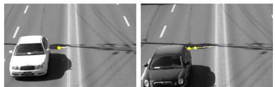
그림 13. 픽셀 정보 유사성에 의해 검출된 벡터들 Fig. 13. Detected vectors by pixel information similarity
