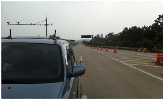
그림 7. WAVE 안테나 다이버시티 실험을 위한 이동차량 Fig. 7. Moving vehicle for WAVE antenna diversity tests
