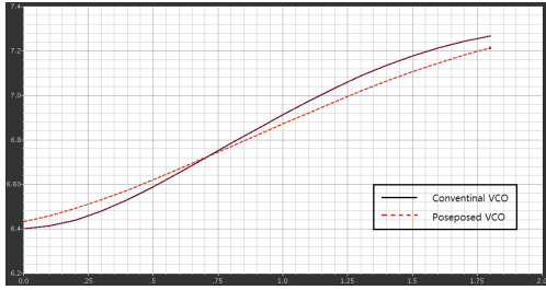
그림 7. 공진 주파수 튜닝 범위 Fig. 7. Oscillation frequency tuning range
