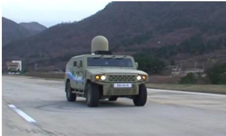
그림 11. OTM 위성통신 시스템의 주행시험 모습
