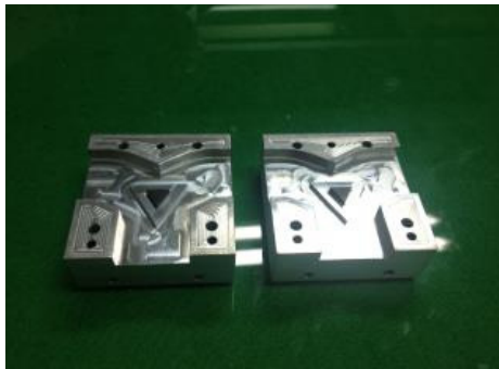
그림 9. 서클레이터의 내부도 Fig. 9. Inside view of circulator
