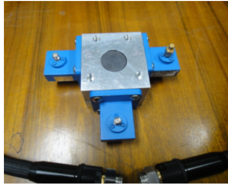
그림 11. 제작된 서클레이터 Fig. 11. Fabricated circulator
