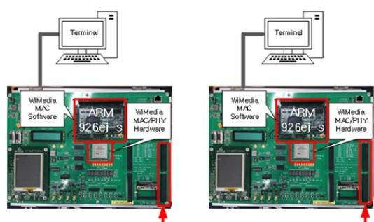
그림 12. 하드웨어 및 소프트웨어 검증을 위한 테스트 플랫폼
