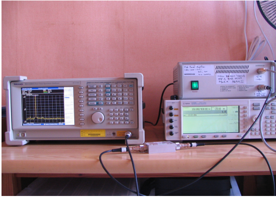
(a) 육상국 송신부 장치 설정 (a) Setup of transmitter on shore
