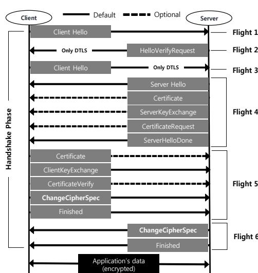
그림 1. DTLS 핸드쉐이크 과정
