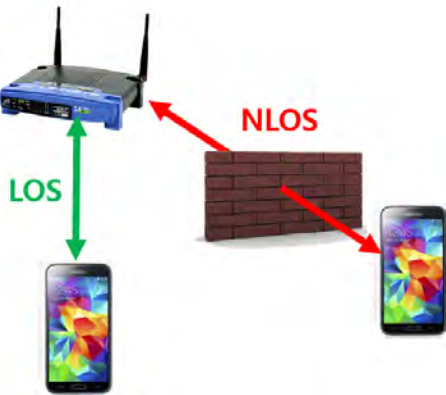
그림 1. LOS와 NLOS의 도식화된 비교 Fig. 1. Schematic comparison of LOS and NLOS
