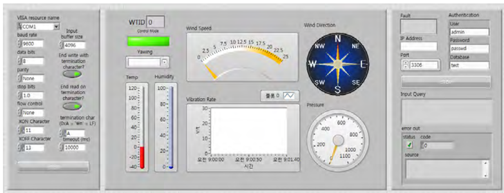
그림 15. LabVIEW 기반의 풍력발전기 모니터링 및 제어 GUI Fig. 15. LabVIEW based GUI for wind turbine monitoring and control
