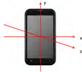
그림 4. 스마트 폰 기본 좌표계 (삼성 갤럭시 S2) Fig. 4. Basic coordinates of smart phone (Samsung S3)
