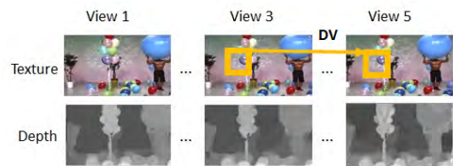
그림 1. 3개의 텍스처 비디오와 깊이 비디오로 구성된 MVD 포맷 10) Fig. 1. MVD format comprising three texture videos and the corresponding depth videos 10)
