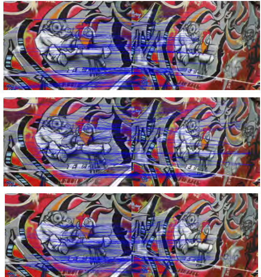
그림 9. 'Graffiti A' 영상의 정합 결과, 제안한 기법(상)과 SURF(중), SIFT(하) Fig. 9. Result of matching by the proposed algorithm(top), SURF(middle) and SIFT(bottom) for 'Graffiti A'
