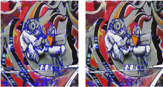
그림 5. FAST 기법과 NMS 기법을 적용하여 특징점을 추출한 영상 그림 5(a) NMS만 적용한 경우 그림 5(b) NMS기법과 주곡률을 모두 적용한 경우 Fig. 5. Feature points extracted by applying FAST algorithm and NMS Fig 5(a) Only with NMS Fig 5(b) With NMS and the principal curvatures
