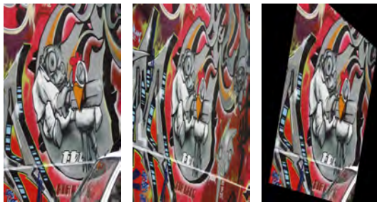
그림 8. 시점이 다른 두 영상과 보정된 영상 그림 8(a) 기준 영상 그림 8(b) 시점이 다른 영상 그림 8(c) 호모그래피를 이용해 보정된 영상 Fig. 8. Two different viewpoint images and the corrected image. Fig 8(a) Reference image Fig 8(b) Query image Fig 8(c) Corrected image by homography
