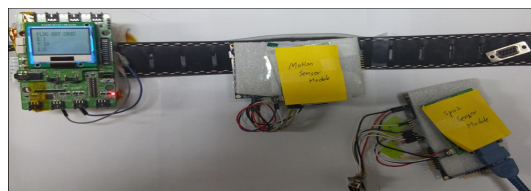
그림 18. 스마트 벨트 동작 중 SpO2 센서 모듈을 Plug Out 했을 때 모습 Fig. 18. View of the Main Module and the Peripheral Modules of the Smart Belt when SpO2 Sensor Modules have Plug-out to the Smart Belt.
