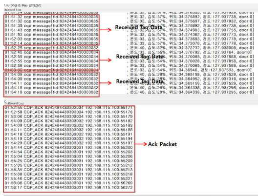
그림 11. 서비스 플랫폼의 태그 패키지 수신 Fig. 11. Received tag packet to service platform
