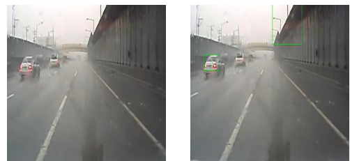
그림 3. (a)원본 영상, (b)옵티컬 플로우 방법을 이용한 차량 검출 결과 Fig. 3. (a)original image, (b)result of vehicle detection using Optical Flow
