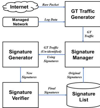
그림 2. 완전 자동화 페이로드 시그니처 업데이트 시스템 흐름도
