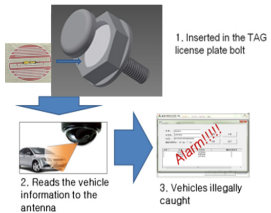
그림 1. UHF RFID 태그를 이용하여 불법차량 검출 시스템 Fig. 1. Illegal vehicle detection system using an UHF RFID tag
