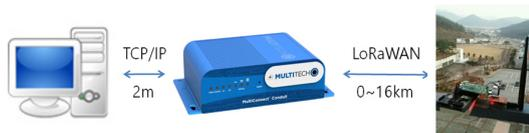
그림 11. LoRaWAN 통신 모듈의 무선 전송 거리 테스트
