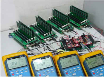
그림 3. 에너지 측정을 위한 임베디드 보드 Fig. 3. Embedded board for energy measuring
