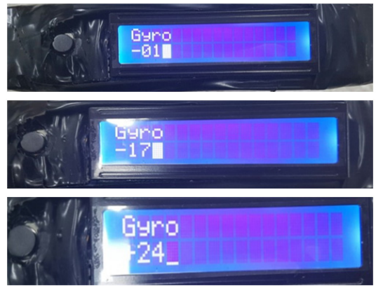
그림 26. 수평 측정 결과 Fig. 26. Horizontal measurement result
