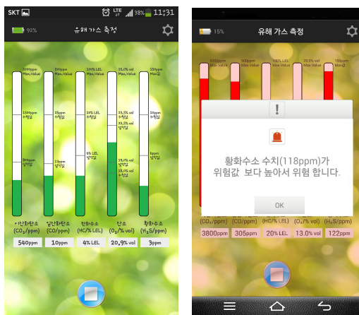
그림 12. 안드로이드 앱 프로그램 (a)메인화면 (b)알람 팝업 Fig. 12. Android app program (a) main display (b) alarm pop-up display
