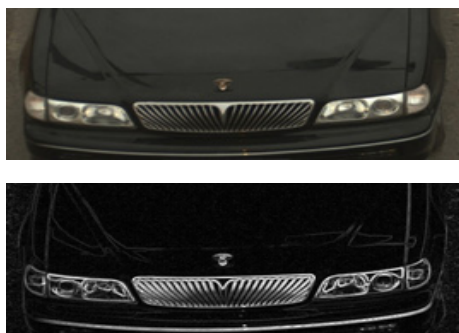
그림 3. 소벨 에지 연산자를 이용한 차량영상 에지검출 Fig. 3. Vehicle edge detection using sobel edge operator.
