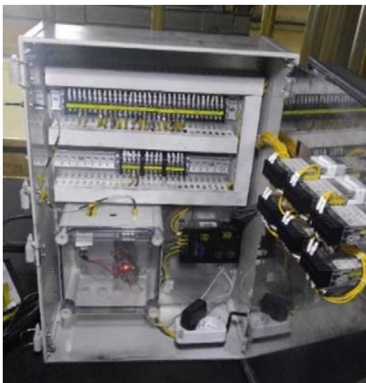
그림 11. 무선 센서 모듈(6개 센서 연동) Fig. 11. Wireless sensor module with 6 sensors
