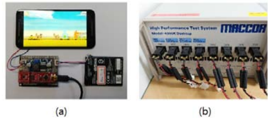
그림 3. (a) 스마트폰의 전류, 전압 측정을 위한 아두이노 (b) 배터리 테스트를 위한 maccor Fig. 3. (a) Arduino for current and voltage measurement of smartphone (b) Maccor for battery testing
