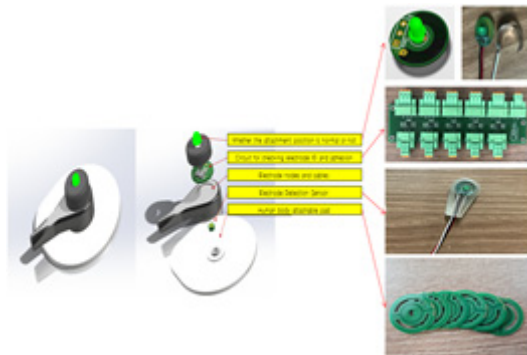
그림 3. 제안된 구조의 생체정보 검출 센서 모듈 Fig. 3. Proposed sensor module for bio-information acquisition
