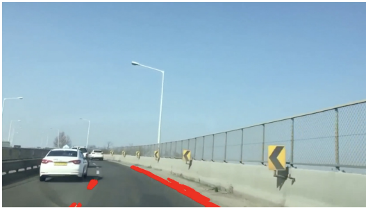
그림 15. (b) 곡선 구간의 HSV 색 검출 결과 Fig. 15. (b) HSV color conversion result of curved area
