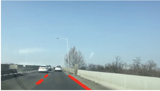
그림 15. (a) 직선 구간의 HSV 색 검출 결과 Fig. 15. (a) HSV color conversion result of straight area
