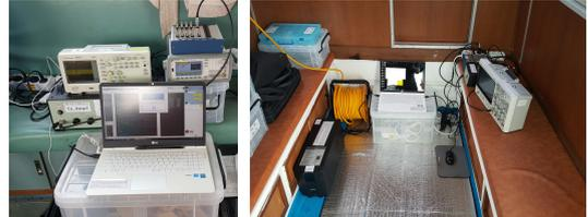
그림 3. 선박 내부에 구성된 송·수신 시스템
