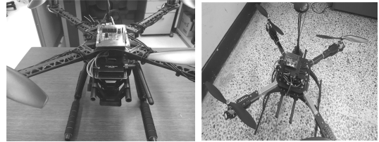
그림 5. 테스트 드론에 탑재된 구현 통신 모듈 설치 모습. Fig. 5. Installation of the Implemented Communication Module into the Test Drone.
