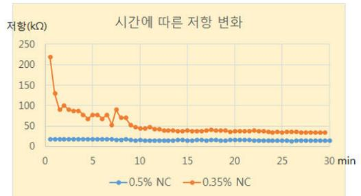
그림 3. CNT 농도 및 시간에 따른 bulk 저항 변화
