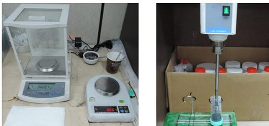
그림 1. 무게 측정용 저울(좌) 및 프로펠러 형 교반 장치(우)
