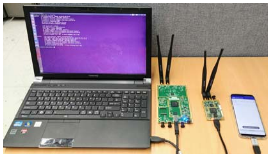
그림 12. 구현 플랫폼. 왼쪽부터 Toshiba 랩탑, USRP B200, USRP B200mini, 갤럭시 S9+. Fig. 12. Implementation platforms. From left to right, Toshiba Laptop, USRP B200, USRP B200mini and Galaxy S9+.
