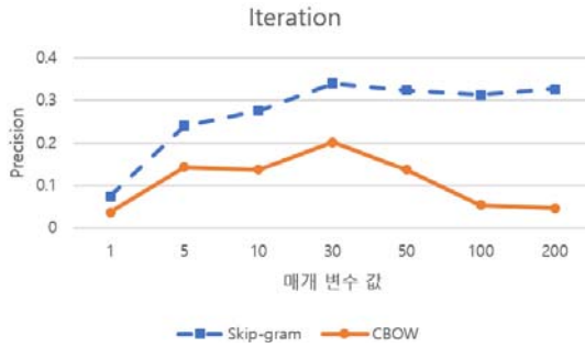
그림 6. Iteration 값 조정에 따른 정밀도 변화 Fig. 6. Precision changes as a function of iteration
