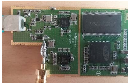
그림 8. 외부 저잡음 증폭기와 DBA 수신기 모듈 Fig. 8. External Low Noise Amplifier and DBA Receiver Module
