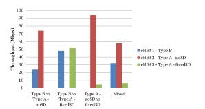
그림 5. 이종 LBT 공존 상황에서 하향링크 수율 Fig. 5. Downlink throughput in the coexistence scenarios of different LBT options
