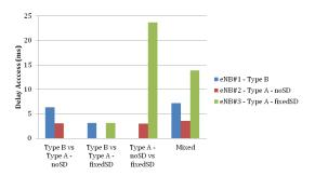
그림 6. 이종 LBT 공존 상황에서 액세스 딜레이 Fig. 6. Access delay in the coexistence scenarios of different LBT options
