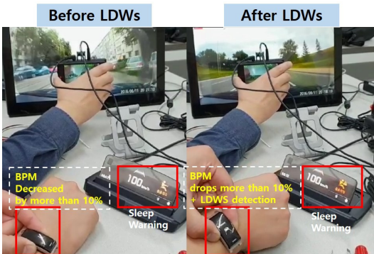
그림 13. LDWS와 웨어러블 밴드의 심박수 하락을 통한 안전운전 보조 테스트 Fig. 13. LDWS and Wearable Band Assisted Driving Safety test by Decreasing Heart Rate
